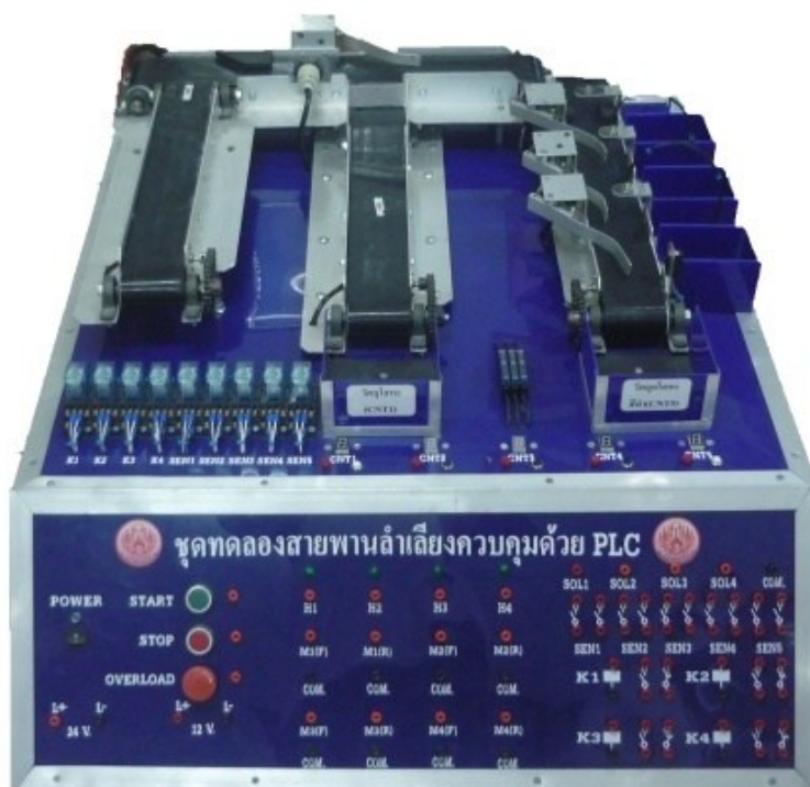
ภาพที่ 6 ชุดทดลองสายพานลำเลียงควบคุมด้วย PLC ที่เสร็จสมบูรณ์
