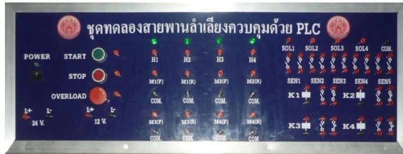
ภาพที่ 2 ด้านหน้าชุดทดลองสายพานลำเลียงควบคุมด้วย PLC
